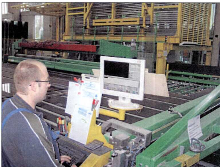
Glas wird passend zugeschnitten: Lars Warmers, Mitarbeiter von Isophon Glas in Gimte, an einem Zuschneidetisch.
